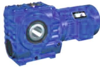
Червячно-цилиндрические редукторы **VRS** имеют червячную-быстроходную ступень с обычными для нее параметрами и одну червячно-цилиндрическую ступень с параметрами цилиндрического редуктора.
