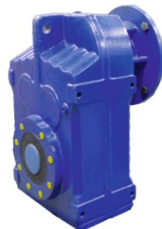
Редукторы цилиндрические с параллельными валами **VRP** являются одной из разновидностей цилиндрических редукторов. Редуктор имеет все преимущества цилиндрических редукторов и отличается от остальных тем, что расположен вертикально. Входной вал расположен в верхней части редуктора, а выходной вал расположен в нижней части редуктора.
